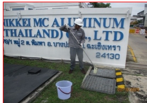
ภาพที่ 2.3-16 การเก็บตัวอย่างคุณภาพน้ำทิ้ง
