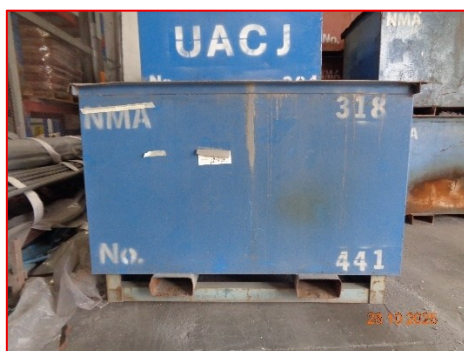
ภาพที่ 2.3-23 ถังเหล็กสำหรับจัดเก็บ Dross
