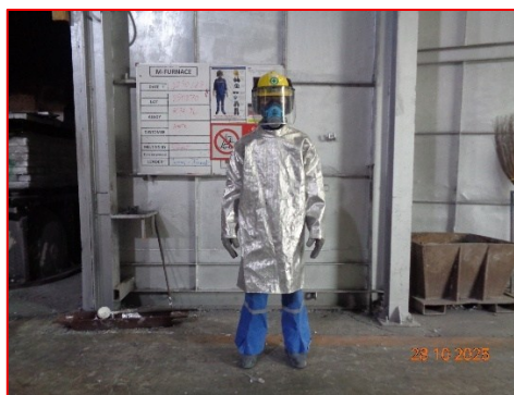
ภาพที่ 2.3-34 พนักงานสวมใส่อุปกรณ์ป้องกันความร้อน และขนาดพ่น Flux
